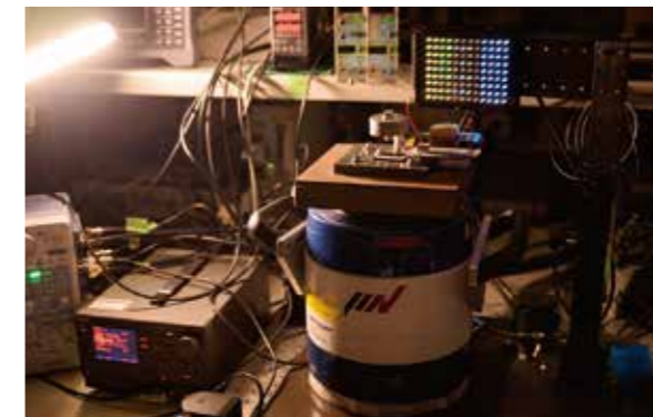
振動発電の実験装置
